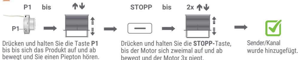
Wenn **KEINE** Endlagen eingestellt sind, bewegt sich das Produkt im Impuls- / Stufenbetrieb. Weiter zu **SCHRITT 3**.
