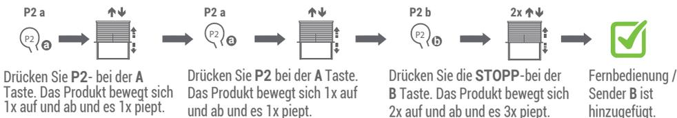
**!** Stellen Sie sicher, dass die Fernbedienung sich auf dem richtigen Sender befindet.
