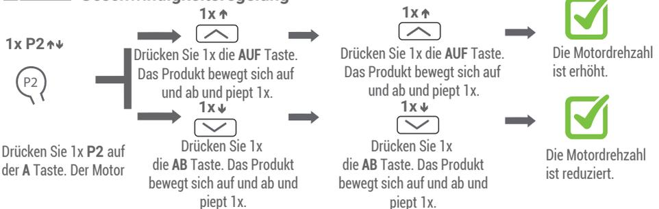
**ⓘ** Wenn der Motor nach dieser Aktion NICHT reagiert, befindet er sich bereits in der höchsten oder niedrigsten Geschwindigkeit.**ⓘ** Es gibt 3 verschiedene Drehzahlen, nämlich : 20rpm - 25rpm - 30rpm.**ⓘ** Wenn die Geschwindigkeit sich ändert, wird die Funktion soft-stop aktiviert. Um diese Funktion aus zu schalten muss der Motor wieder in die Werkseinstellung zurückgesetzt werden.-
