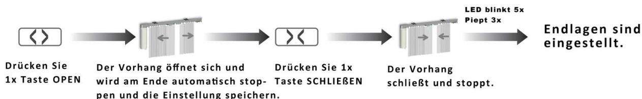
**Hinweis:** Sobald die Endposition eingestellt ist, geht der Motor in den Benutzermodus über; nachdem die Endposition entfernt wurde, geht der Motor in den Impulsbetrieb über.
