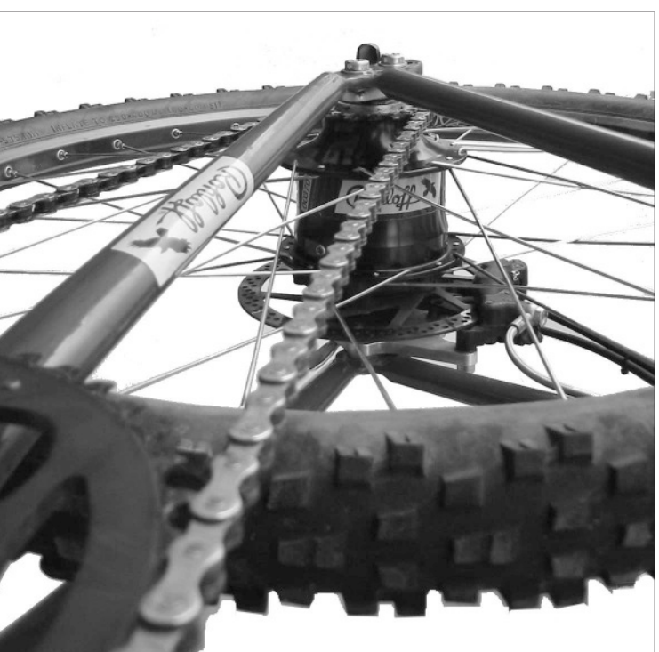
Rohloff SPEEDHUB 500/14 CCDOEM gemonteerd in een frame met verschuibare Rohloff OEM uitvalleinden
