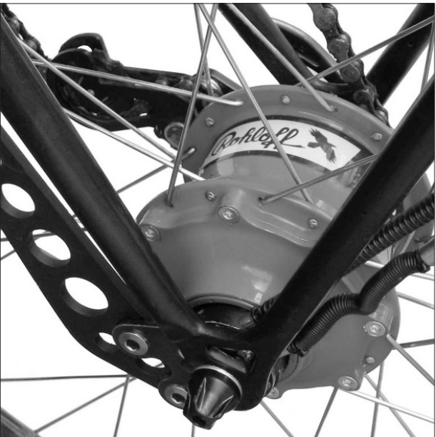
Rohloff SPEEDHUB 500/14 CC met lange draaimomentsteun
