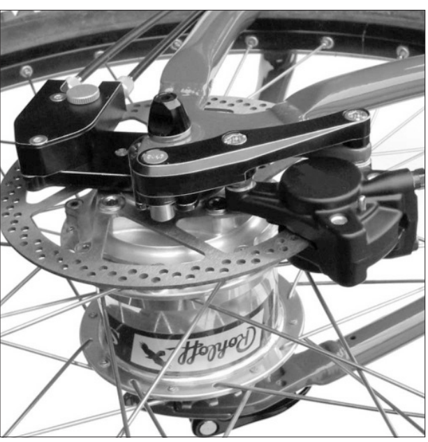
RohloffSPEEDHUB500/14 CCOBOM2 gemonteerdmet RohloffSPEEDBONE enschijfrem
