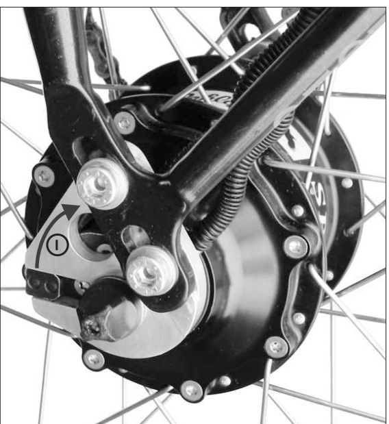
Rohloff SPEEDHUB 500/14 COEM gemonteerd in een frame met verschuifbaar Rohloff OEM uitvaleinde.
