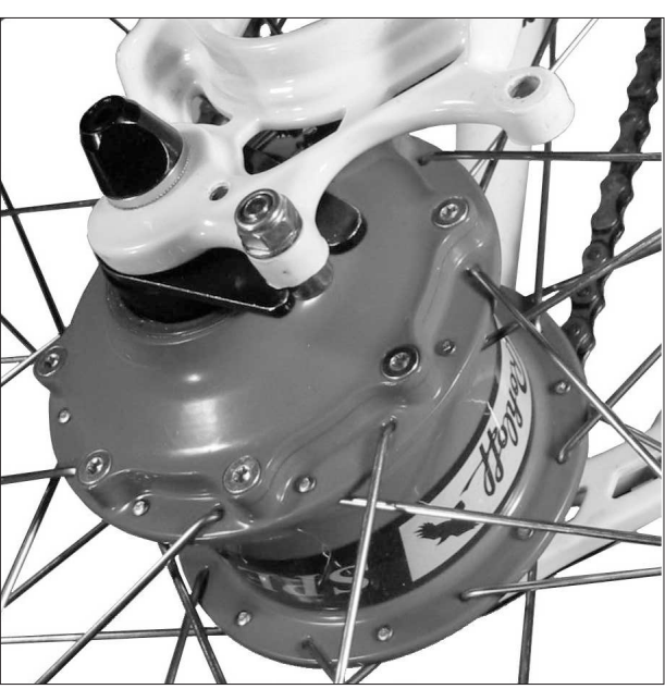
RohloffSPEEDHUB500/14 CCOEM2 gemonteerdmsteunschroef
