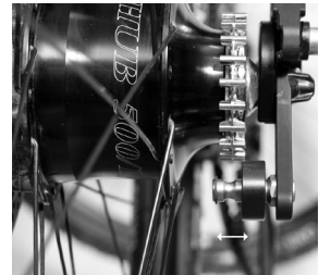
Afbeelding 1: voor montage/demontage van het achterwiel
