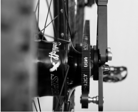
Afbeelding 3: correcte uitlijning van de riem
