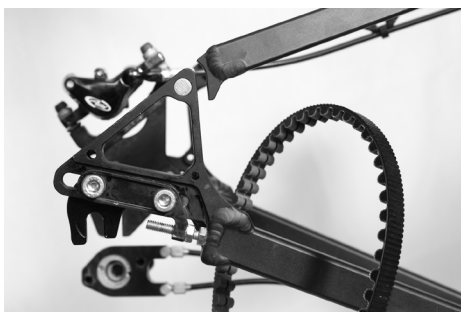
Afbeelding 1: openen van het frame voor montage van de riem
