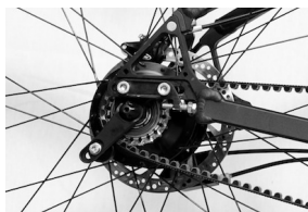
Afbeelding 3: Zijaanzicht van de gemonteerde snubber
