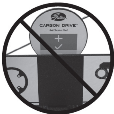
Afbeelding 1: te hoge riemspanning
