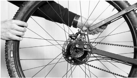
Afbeelding 3: correcte uitlijning van de riem
